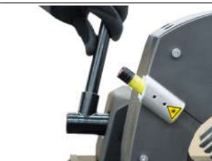
Fixation du mors de serrage (GF 4 (AVM/MVM) uniquement)
