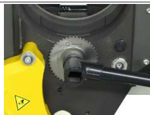
Fixation de la lame de scie/fraise
