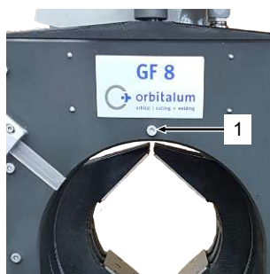
Position de la vis de blocage (1) pour le modèle GF 8 et GF 12 (AVM/MVM).
