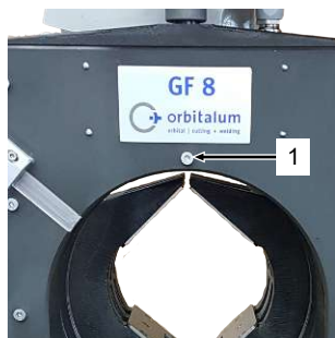
GF 8、GF 12 (AVM/MVM) 上锁 定螺钉 (1) 的位置。
