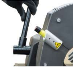
夹钳紧固 (仅在 GF 4 (AVM/MVM) 中)
