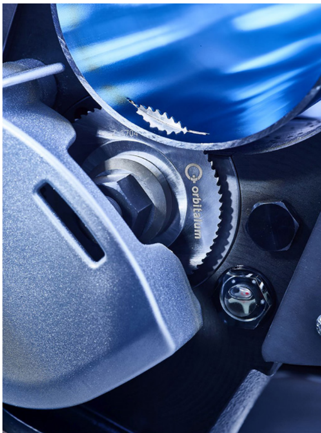
◀ Bild 1. Mit Rohrtren- und -anfasmaschinen gelingt die optimale Fugenvorbereitung für das Orbitalschweißen.
