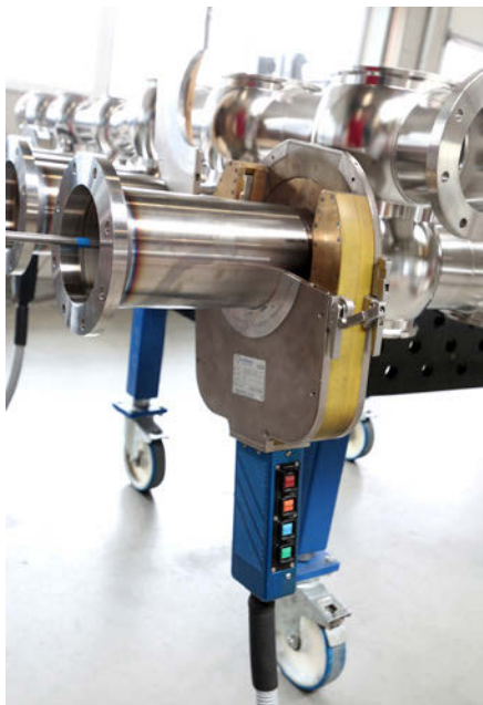
Mit vier unterschiedlich großen „Orbiweld“-Schweißköpfen lassen sich Rohrdurchmesser von 3 bis 170 mm bearbeiten.
