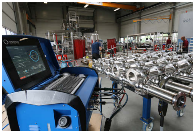
Die Schweißstromquelle „Orbimat 180 SW“ lässt sich leicht per Touchscreen oder Drehsteller bedienen.
