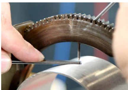
Bei geöffnetem Schweißkopf gelingt die exakte Einstellung der Schweißelektrode zum Rohr hin im Handumdrehen.
