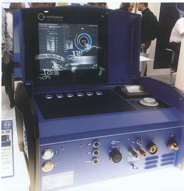
La nouvelle « valise » de pilotage de procédé présentée par Orbitalum est destinée à assurer une surveillance des paramètres de soudage, mais est également capable d'assurer la protection des équipements.
