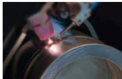
SALDATURA ORBITALE CON LA SERIE ORBIWELD TP
