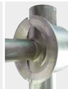
Collari di serraggio per saldatura di raccorderia "T" con possibilità di montaggio del tubo allargato e del tubo da saldare
