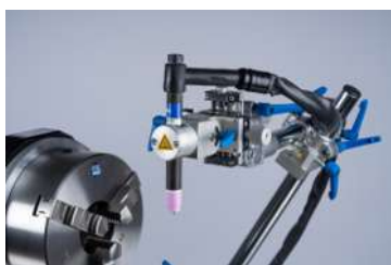
Abb.: Supporto torcia con giunti su slitta a croce per la regolazione di precisione.
