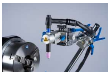
Fig.: Support de torche avec articulations sur chariot croisé pour un réglage précis.
