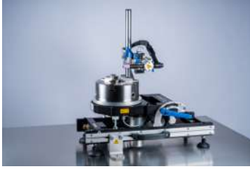
Abb.: DVR M eingestellt für Vertikal-schweißungen
