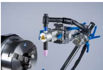
Abb.: Brennerhalter mit Gelenken auf Kreuzschlitten zur Feineinstellung.
