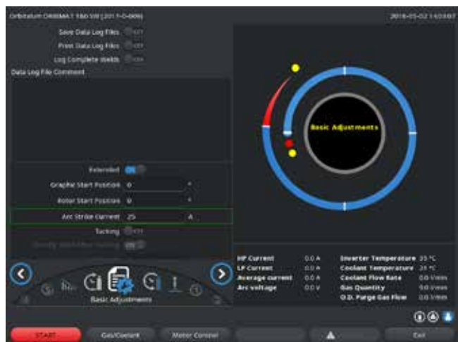
Abb. 12: Zadávací pole – Zapalovací proud a čas tvoření lázně
