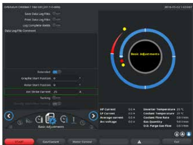
Abb. 12: Champ d'introduction – Courant d'amorçage et temps d'amorçage
