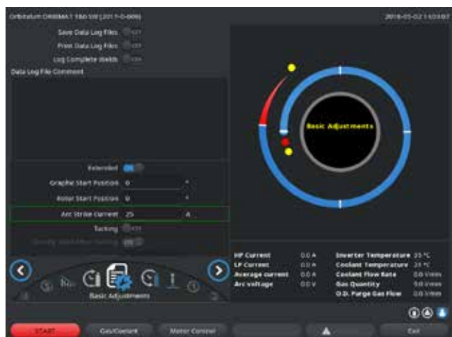
Abb. 12: Campo de entrada – Corriente de encendido y tiempo de retraso en el arranque del motor
