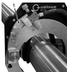
Obr.: Kloubové rameno hořáku v základní pozici
