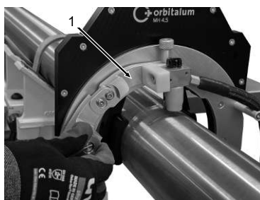
Obr.: Kloubové rameno hořáku sníženo
