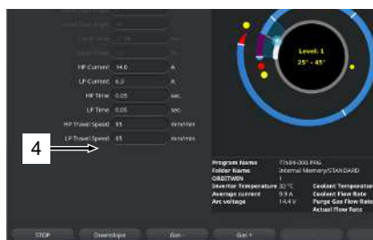
Obr.: Pozice hořáku a počáteční pozice svařovací program v pozici 9 hodin
