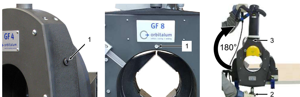
Posizione della vite di sicurezza Posizione della vite di sicurezza (1) per GF 4 e GF 6 (AVM/MVM). (1) per GF 8, GF 12 (AVM/MVM).
