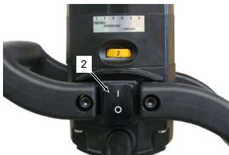
Interruttore a levetta ON/OFF sul motore
