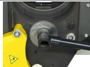
Fissaggio della lama/fresa
