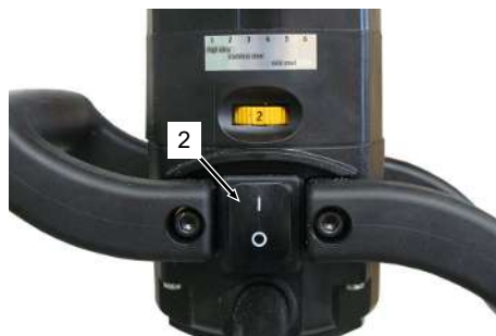
Interruttore a levetta ON/OFF sul motore
