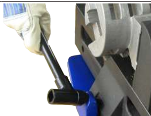
Fissaggio della lama sulla piastra di montaggio rapido
