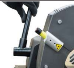
Fissaggio delle ganasce (solo per GF 4 (AVM/MVM))
