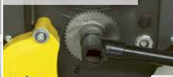
Clé multifonction pour tous les réglages sur la machine
