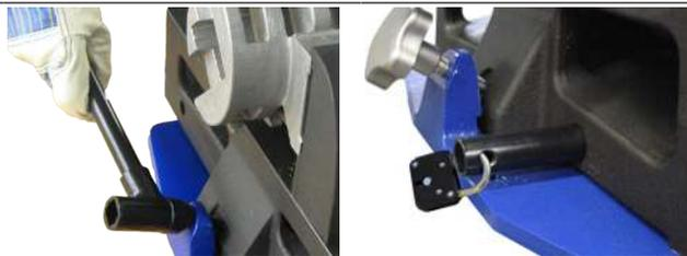
*Befestigung der Säge auf der Säge auf der Schnellmontageplatte* *Verriegelung des Drehkörpers schützt vor unerlaubter Benutzung und Diebstahl.*
