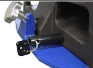
*Zablokování otočného tělesa chrání před neoprávněným použitím a krádeží.*
