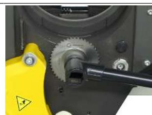
Upevnění pilového listu/frézy
