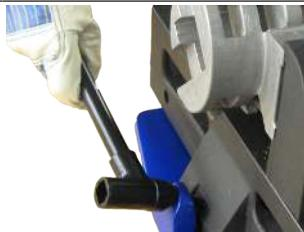
*Upevnění pily na pile na rychlomontážní desce*
