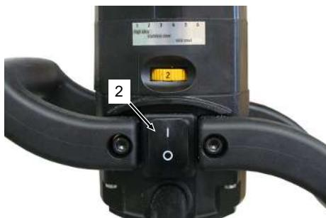
Spínač ZAP/VYP na motoru
