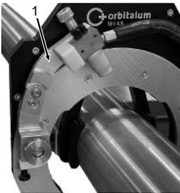
图示：焊炬连接臂位于基本位置
