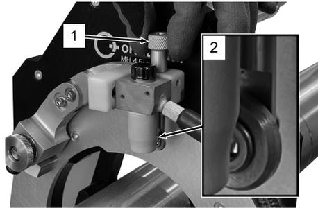
1. 将焊炬连接臂固定在电流-气体软管 (3) 上。
